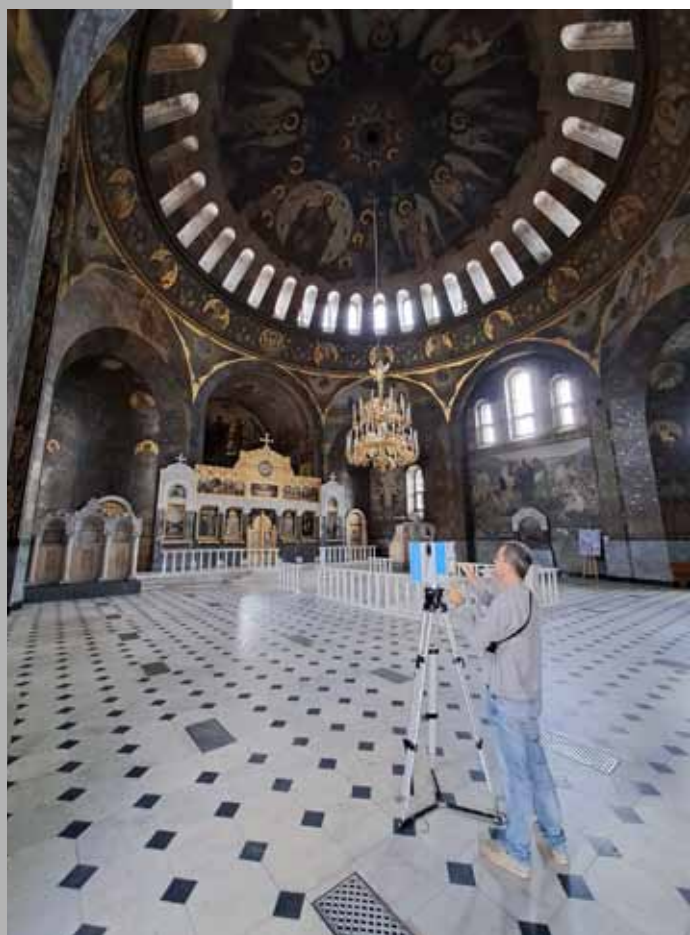
Chiesa dei Santi Antonio e Teodosio : Stazione di scansione in interno e riprese fotografiche per il modello fotogrammetrico dell'interno.
