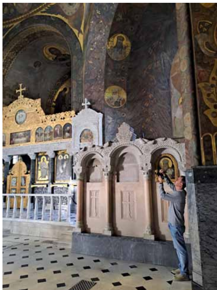
Chiesa dei Santi Antonio e Teodosio : Stazione di scansione in interno e riprese fotografiche per il modello fotogrammetrico dell'interno.
